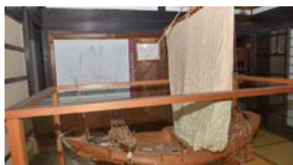
当時の典型的な廻船「弁財船」の模型。俗に言う「千石船」はこのタイプを指す。
